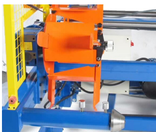
TR145/R Bobinadora abatible R427 dentro de la máquina Coiling device R427 inside machine
